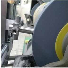
圖(40)測試棒實際磨削圖
