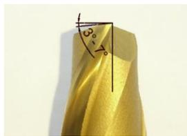
圖(3)軸向間隙角
