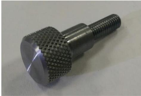
圖(29)刀座鎖緊螺絲
