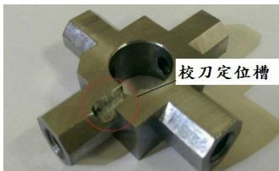
圖(27) 校刀定位槽
