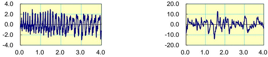
間隙角  $12^\circ$  進入端表面粗糙度為 Ra 1.456 $\mu\text{m}$       間隙角  $12^\circ$  切削至尾端時，粗糙度為 Ra 2.064 $\mu\text{m}$
